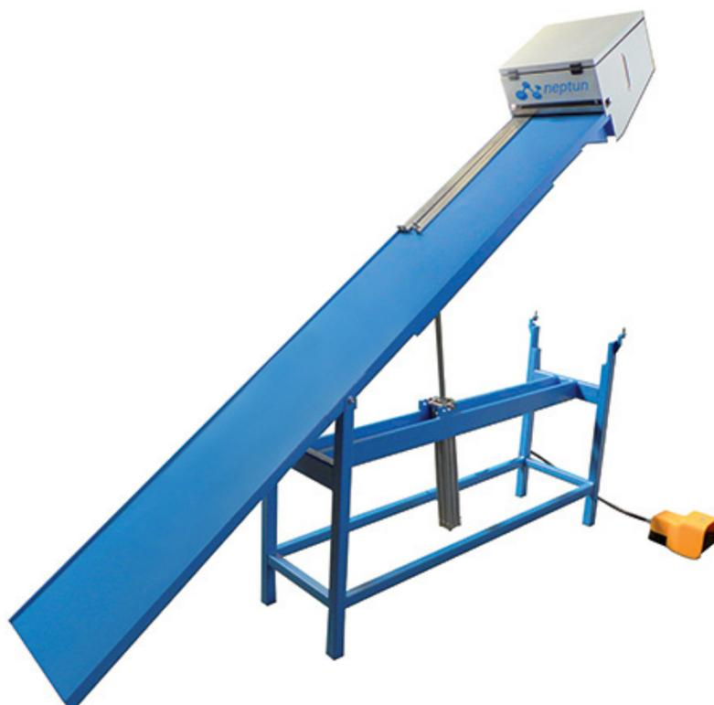
Sistemi di carico di Sali essiccanti per i profili di alluminio con funzione vibrante per ridurre i tempi di carico. SL-20 consente di caricare fino a 20 profili contemporaneamente.
