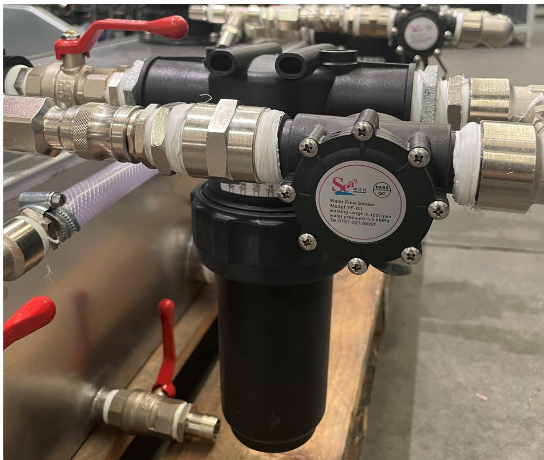
Flussostati per controllo stato pulizia filtri
