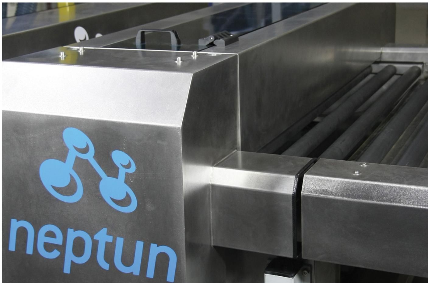
Il modulo addizionale di prelavaggio con spazzole è completo di spazzola superiore ed inferiore, vasca e pompa, ventilatore e lama d'aria superiore. Particolarmente indicato in caso di vetri molto sporchi che necessitano un prelavaggio aggressivo.
