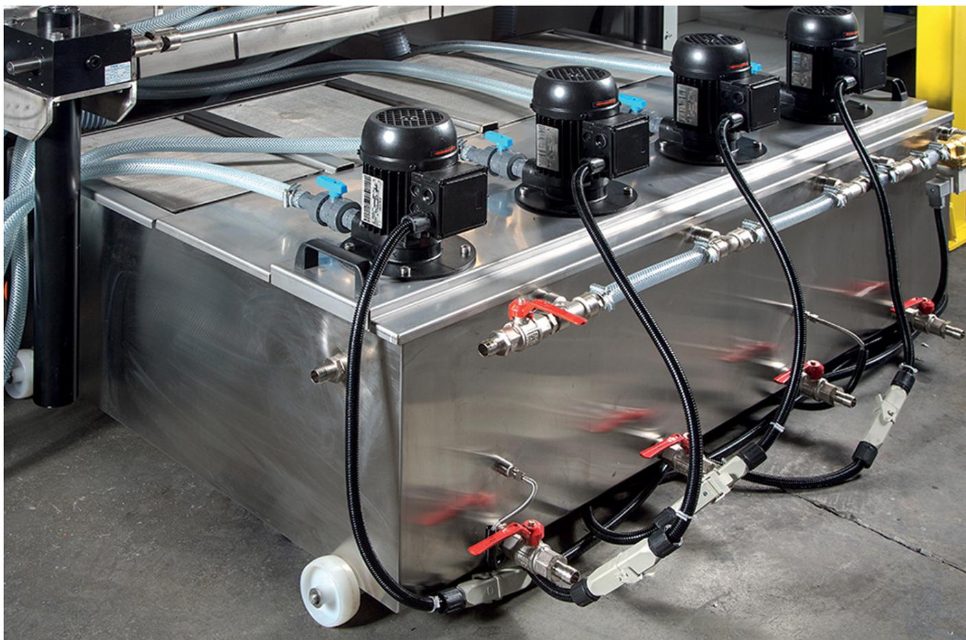
Possibilità di riscaldare l'acqua e mantenere la temperatura fino a 60°, con resistenze, termostati e sensori di protezione resistenza in caso di calo del livello dell'acqua. Vasca estraibile in acciaio inox molto compatta per minimo ingombro e facile manutenzione.
