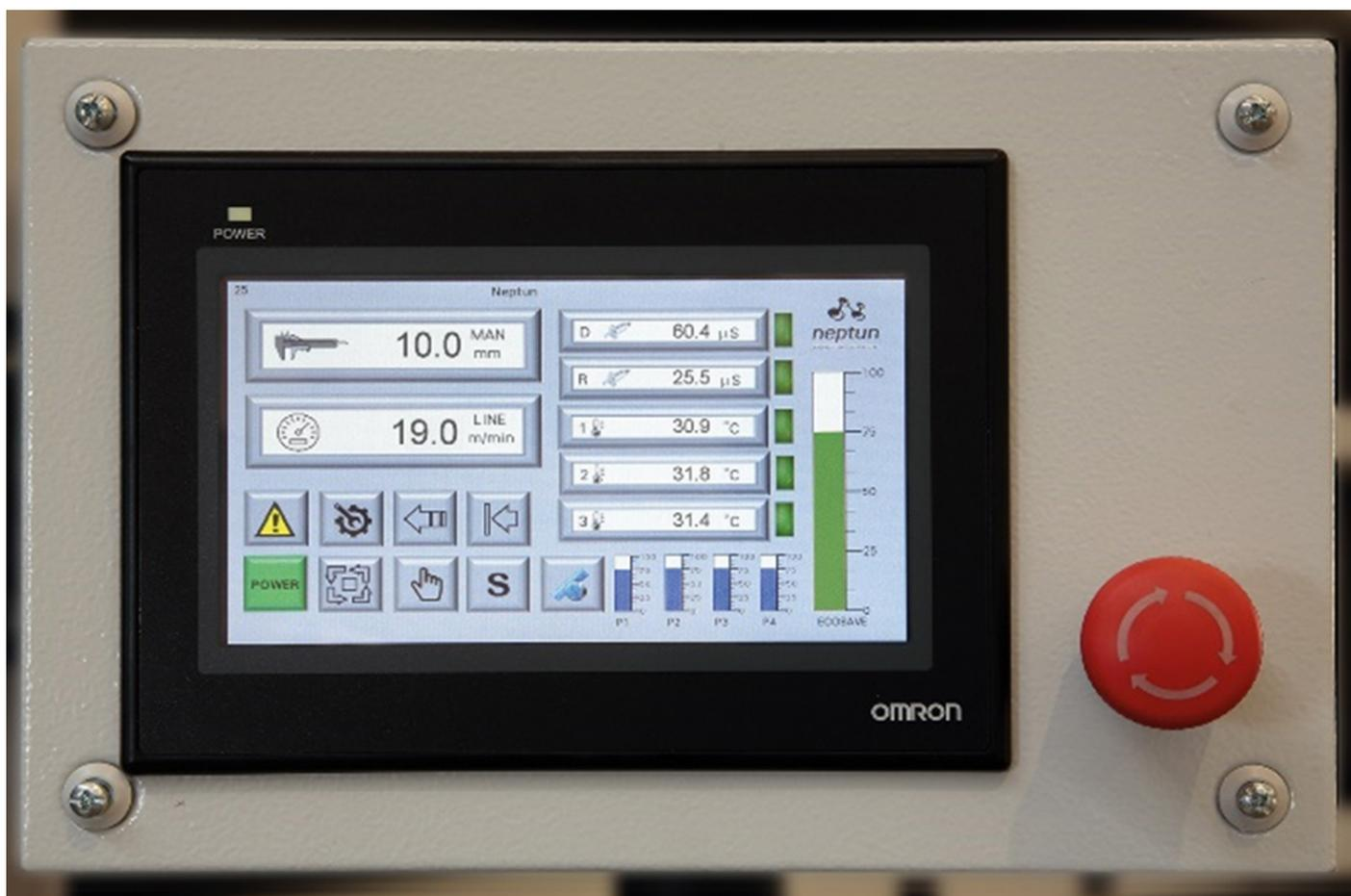
Ad un orario prefissato impostato sul pannello di controllo, il CN attiva lo svuotamento automatico delle vasche, al termine del quale queste vengono riempite nuovamente in modo da avere ad inizio turno l'acqua nuova, la funzione è impostabile per ogni giorno della settimana.
