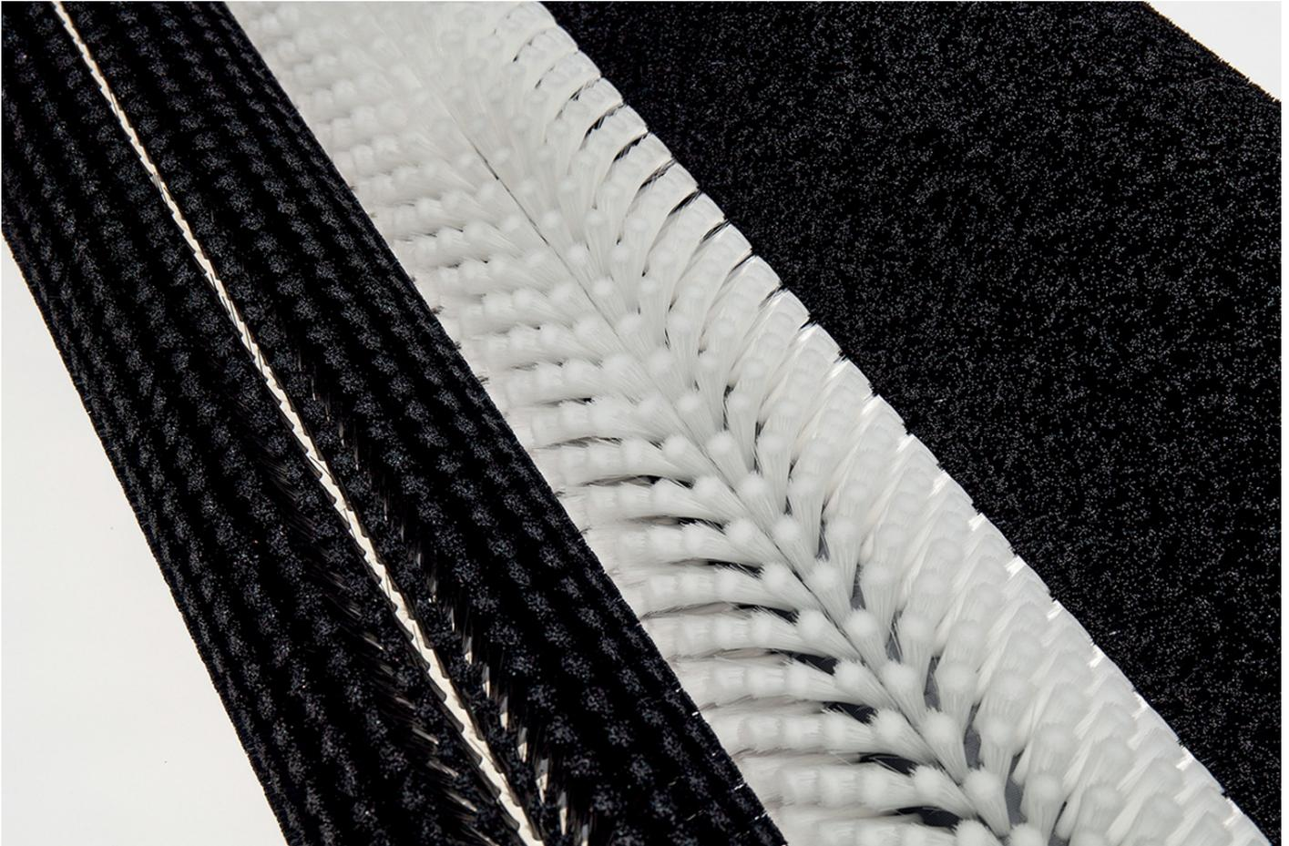
Spazzole con diverse caratteristiche per le esigenze di lavaggio più complesse (laminazione, bassi emissivi, spruzzatura ceramica e UV, solare, etc.). La velocità di rotazione può essere gestita da inverter.
