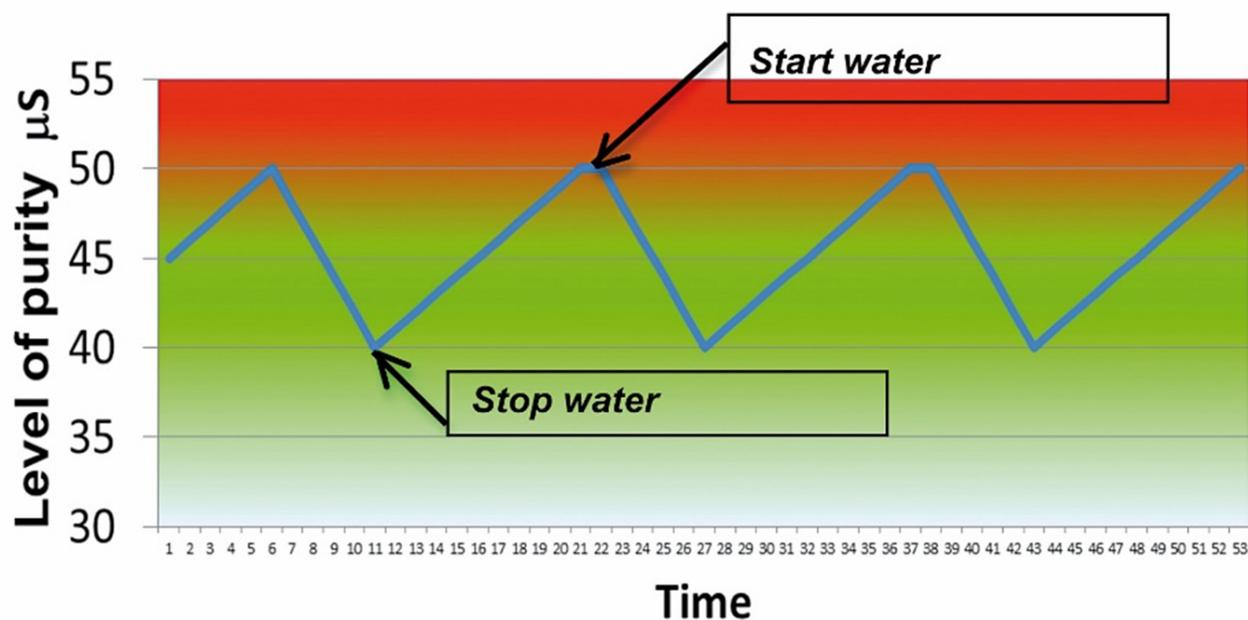
Circuiti d'acqua configurabili a seconda dell'applicazione, con filtri in ingresso e uscita, pompe e sezioni vasche dedicate. Sistema di controllo e gestione qualità dell'acqua, che immette automaticamente acqua pulita in funzione del livello di purezza richiesto.
