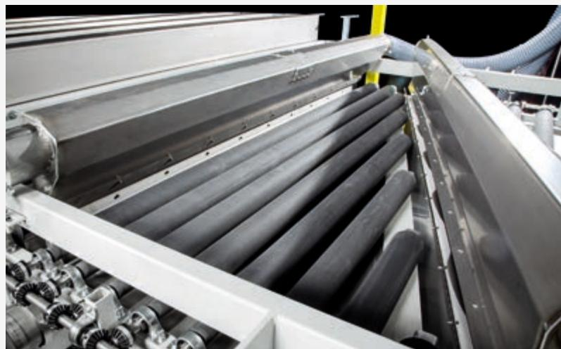
Zona di lavaggio completamente in acciaio inox. Soffianti di asciugatura e lamiera di raccolta acqua in acciaio inox.
