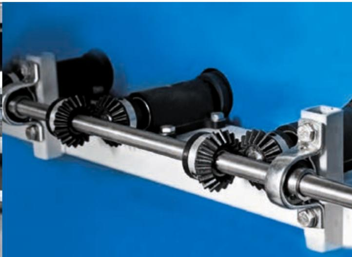
Trasporto vetro con rulli in gomma antigraffio, movimentati da coppie coniche esenti da manutenzione. Trasmissione meccanica in acciaio inox. Alberi dei rulli di trasporto e delle spazzole in acciaio inox.
