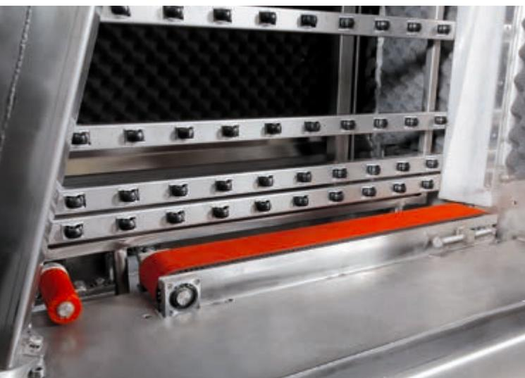
Il sistema di trasporto in asciugatura con cinghia touchless permette la massima aderenza del filo del vetro e una ottimale asciugatura della superficie senza lasciare i caratteristici segni dei rulli di trasporto.
